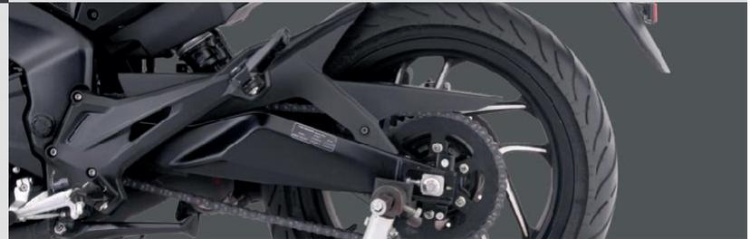
Garantir a aplicação de torque de 10 Kg.m (98,1 N.m) na porca do eixo traseiro.
